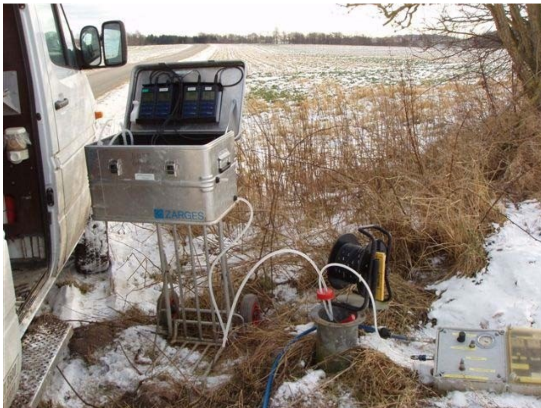
Figur 5. Eksempel på opstilling af udstyr til feltmålinger ved en montejust-pumpe. Bemærk automatikboksen på jorden til at styre prøvetagningen.
