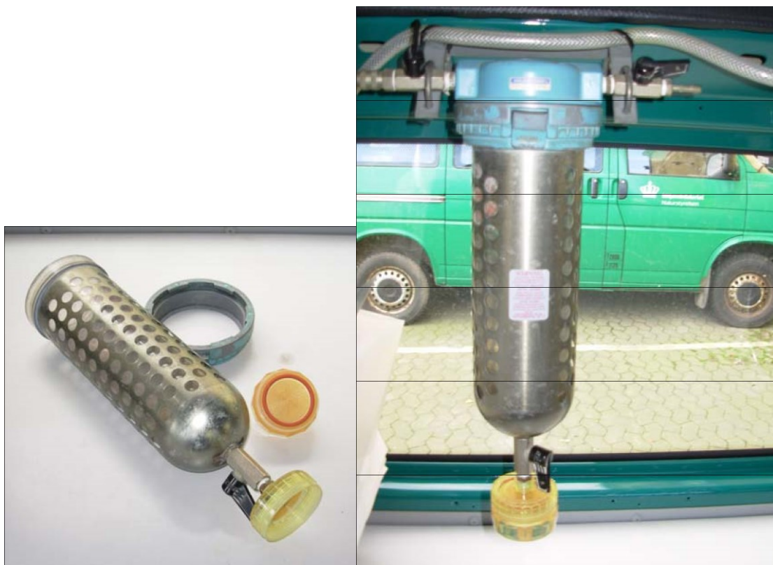
Figur 3. Trykfiltreringsudstyr fra LOOP og borerer med utilstrækkeligt pumpetryk, her filterhus og filterholder, samt opstilling i feltbilen, med gas til trykfiltrering monteret.
